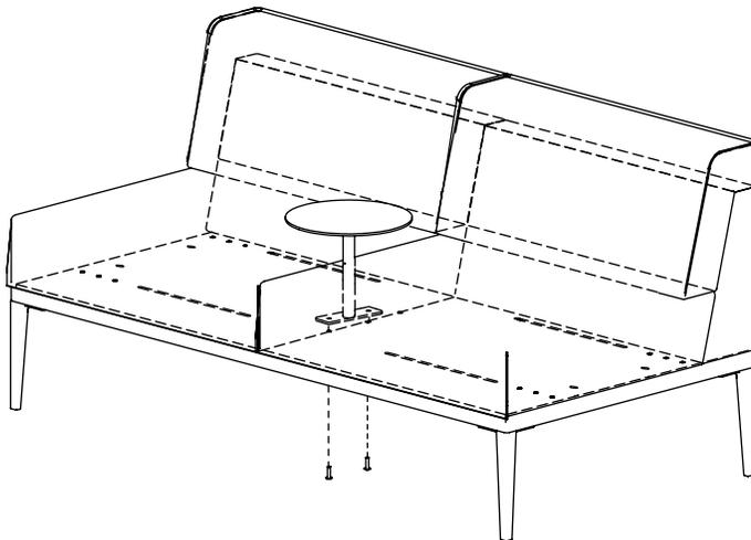
Insérez 2 vis 1/4-20 x 1" à tête ronde sous la planche de sièges pour fixer la tablette entre les sièges.
