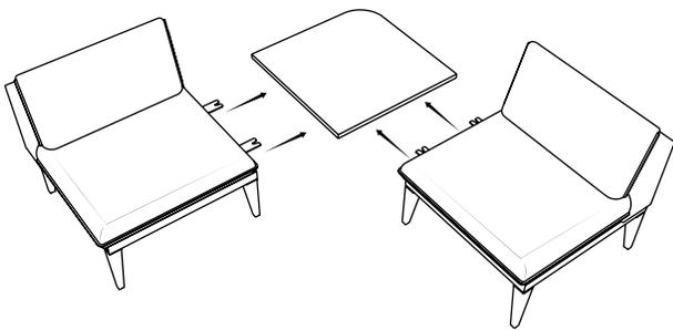
Placez la tablette en coin, entre deux sièges, et s'assurer que les plaques de connexion MBC5 soient alignées avec les inserts de la tablette.
