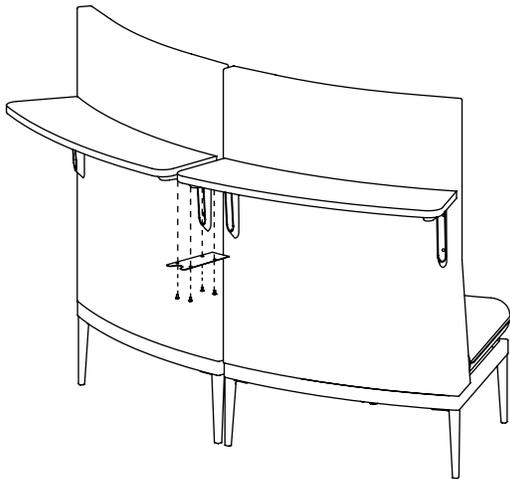
Assemblez la plaque mitoyenne sur les 2 tablettes en utilisant 4 vis 1/4-20 x 1/2" à tête fraisée.
