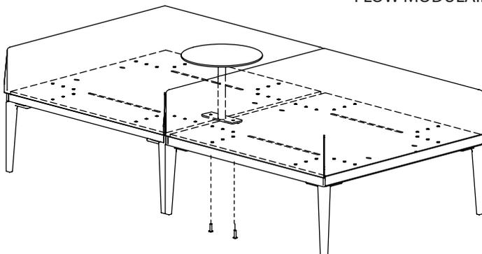
Insérez 2 vis 1/4-20 x 1" à tête ronde sous la planche de sièges pour fixer la tablette entre les sièges.
