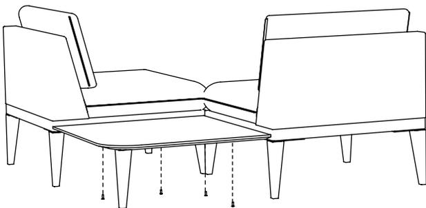
Grâce à 4 vis 1/4-20 x 3/4" à tête fraisée, assemblez la tablette aux 4 plaques de connexion MBC5.
