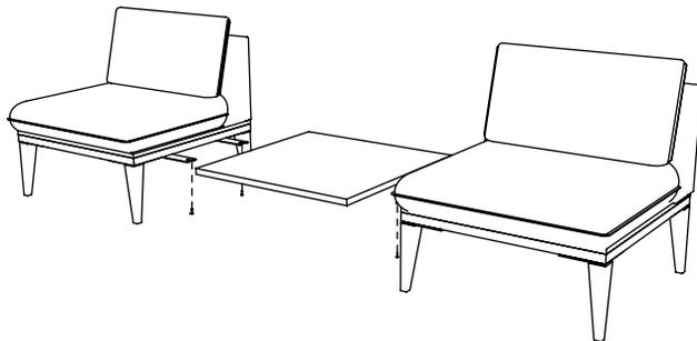
Grâce à 4 vis 1/4-20 x 1" à tête ronde, assemblez la tablette aux 4 plaques de connexion MBC5.
