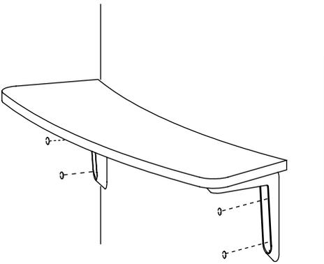
Aposez les cache-vis sur les 4 vis à l'intérieur des équerres.
