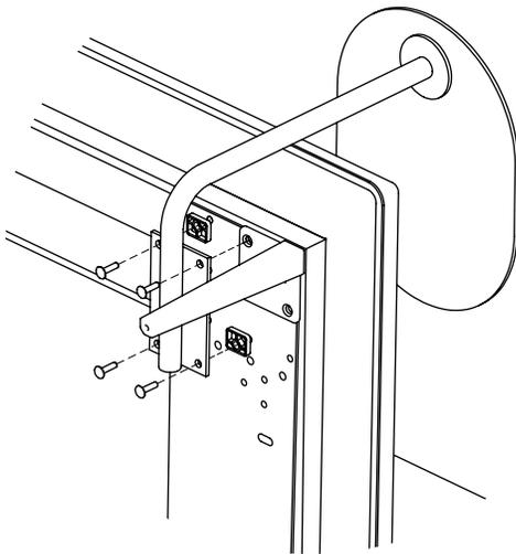
Fixez la tablette au siège à l'aide de 4 vis 1/4-20 x 1-1/4" à tête ronde. Pour l'une des vis, utilisez directement l'insert prévu pour le piétement. Pour les 3 autres, passez la vis au travers des blocs et ensuite dans la planche du siège.
