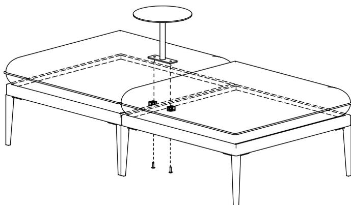
Placez 2 blocs 3/4" entre la planche de siège et la tablette pour que tout soit à niveau. Insérez 2 vis 1/4-20 x 1.75" à tête ronde sous la planche de sièges, au travers des blocs pour fixer la tablette entre les sièges.
