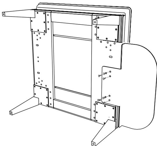
Assemblez la tablette d'extrémité à l'avant ou à l'arrière du siège grâce à 6 vis 1/4-20 x 1" à tête ronde.
