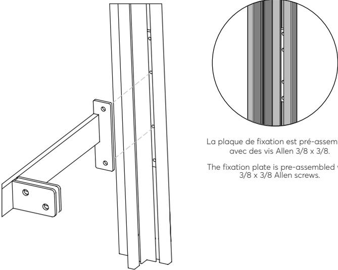
La plaque de fixation est pré-assemblée avec des vis Allen 3/8 x 3/8.
