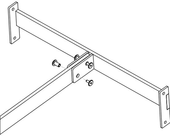
Alignez les trous pré-perçés de la barre transversale et du support latéral. Assemblez les pièces à l'aide des boulons à tête hexagonale #4 15 mm et des boulons à tête hexagonale #5 12 mm.
