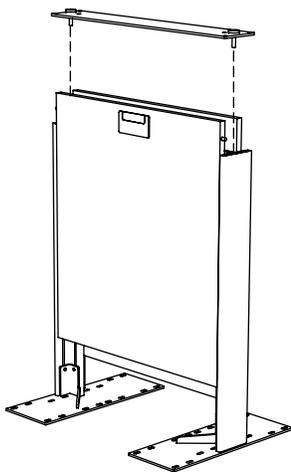
Glissez les panneaux dans les rainures verticales du piètement grâce aux goujons du panneau B.
