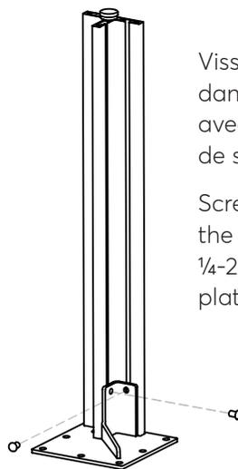
Vissez le contrevent de la plaque dans les rainures du piètement avec les vis 1/4-20 1/2" et les lames de serrages.
