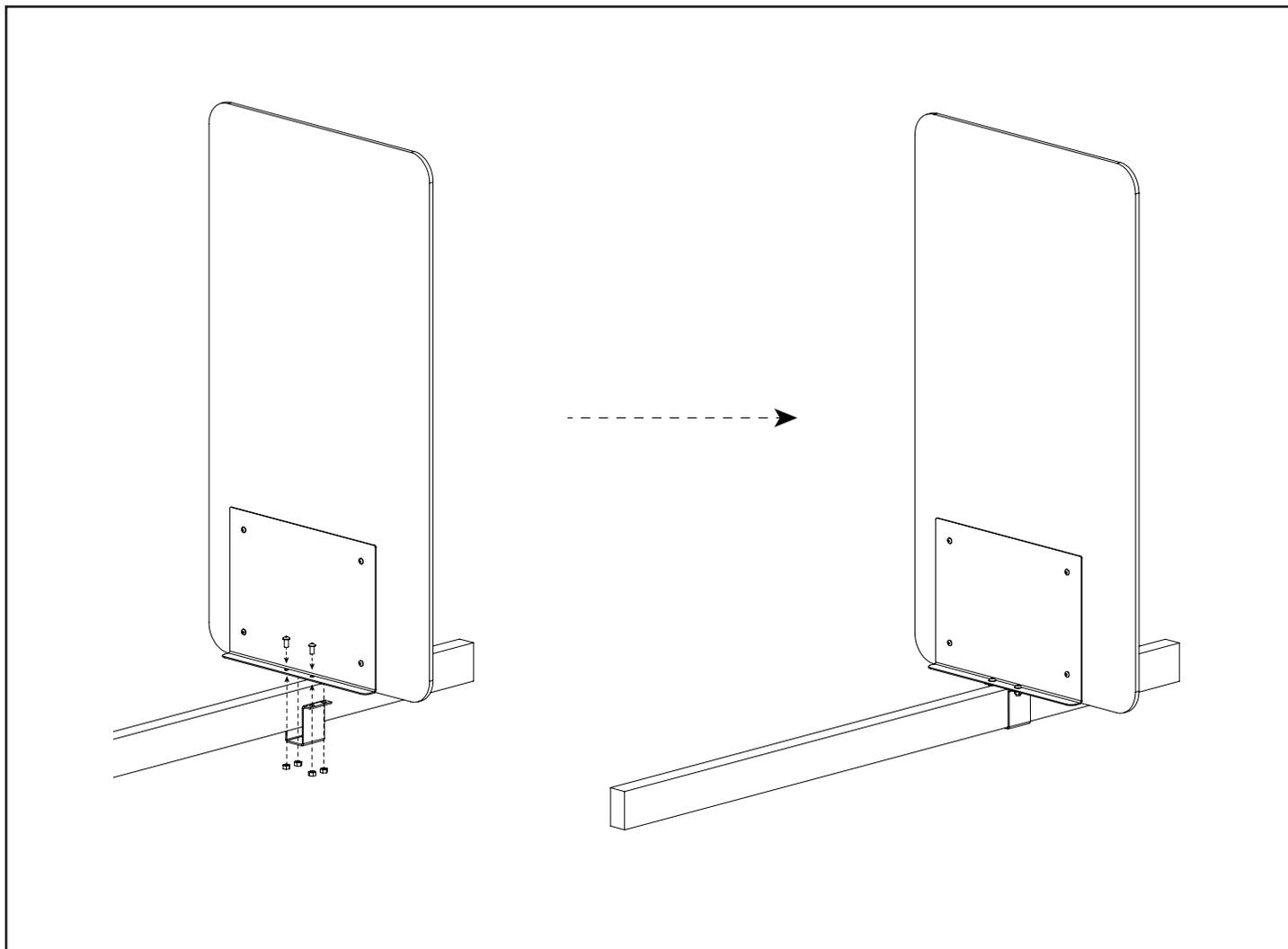
Fixer le panneau d'acrylique et la ferrure en U sur la poutre et ce, à l'aide des vis et écrous fournis.
