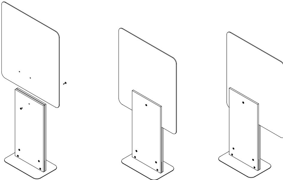
Assemblez l'acrylique avec la base, utiliser le trou approprié afin d'obtenir la position centrée ou décentrée.
