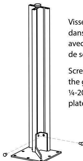
Vissez le contrevent de la plaque dans les rainures du piétement avec les vis 1/4-20 1/2" et les lames de serrages.
